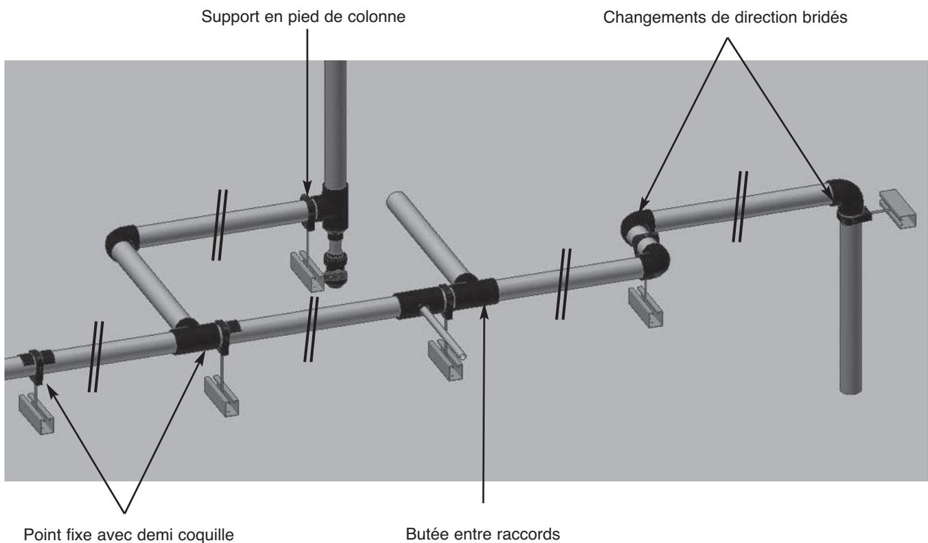
Divers accessoires ou points singuliers nécessitent un supportage particulier : chaque cas de figure doit être étudié afin d'éviter que les tubes aient à supporter des efforts mécaniques.
