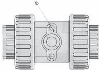
• Toutes nos vannes disposent d'un système de supportage intégré dans le corps de vanne.
