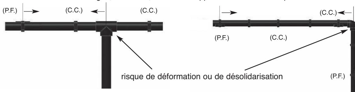
(1) PF : c'est un support qui bloque la canalisation en un point, en vue de "diriger" les mouvements dus à la dilatation et à la contraction.
