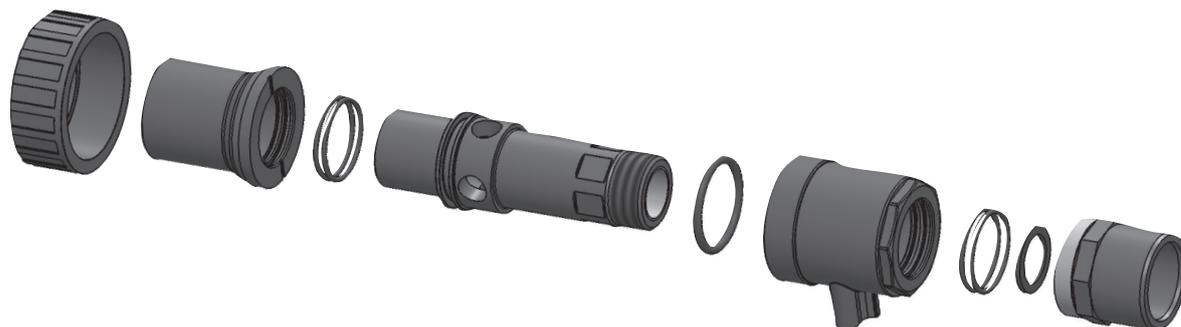
Vérifier avant le montage que le piston n'a pas été rayé et la pièce endommagée.
