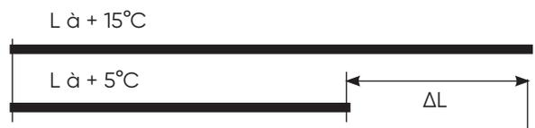
**ABaque pour la détermination rapide de  $\Delta L$  découlant de la formule de calcul  $\Delta L$  (voir fiche technique 5.2)**
